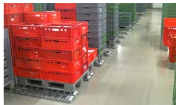
Rollenbahn ohne Gefälle in einer Bereitstellungszone
